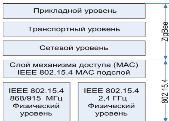
Рис. 1.13 Эталонная модель для беспроводных сенсорных сетей 57
