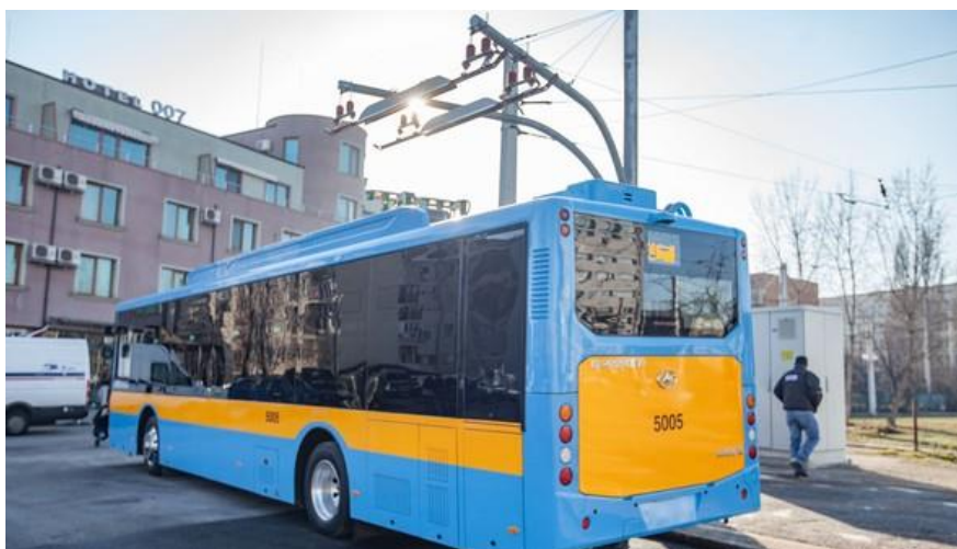
Рис.2.7. Зарядная станция для электрических троллейбусов в Софии
