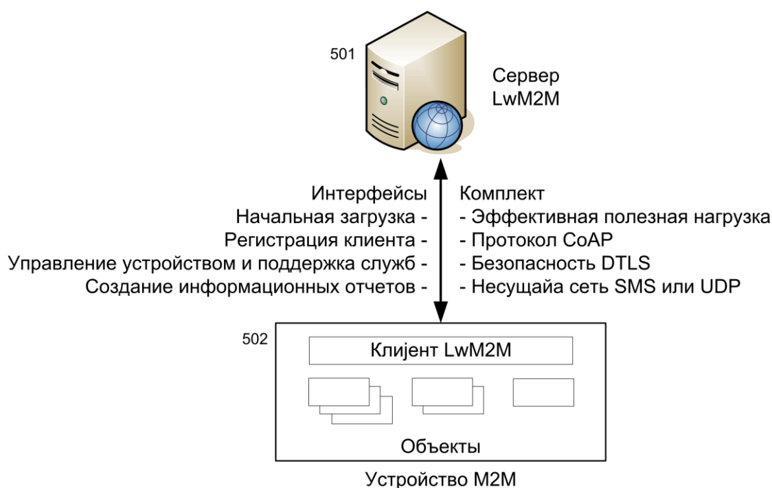
Рис. 1.22 Архитектура LWM2M
