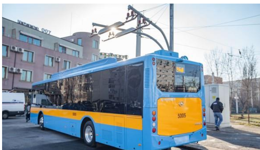
Рис.2.7. Зарядная станция для электрических троллейбусов в Софии
